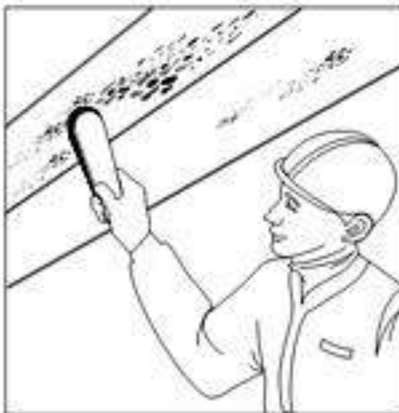
Рисунок 6.1. Очистка конструкции стальной щеткой металлической ручной.
